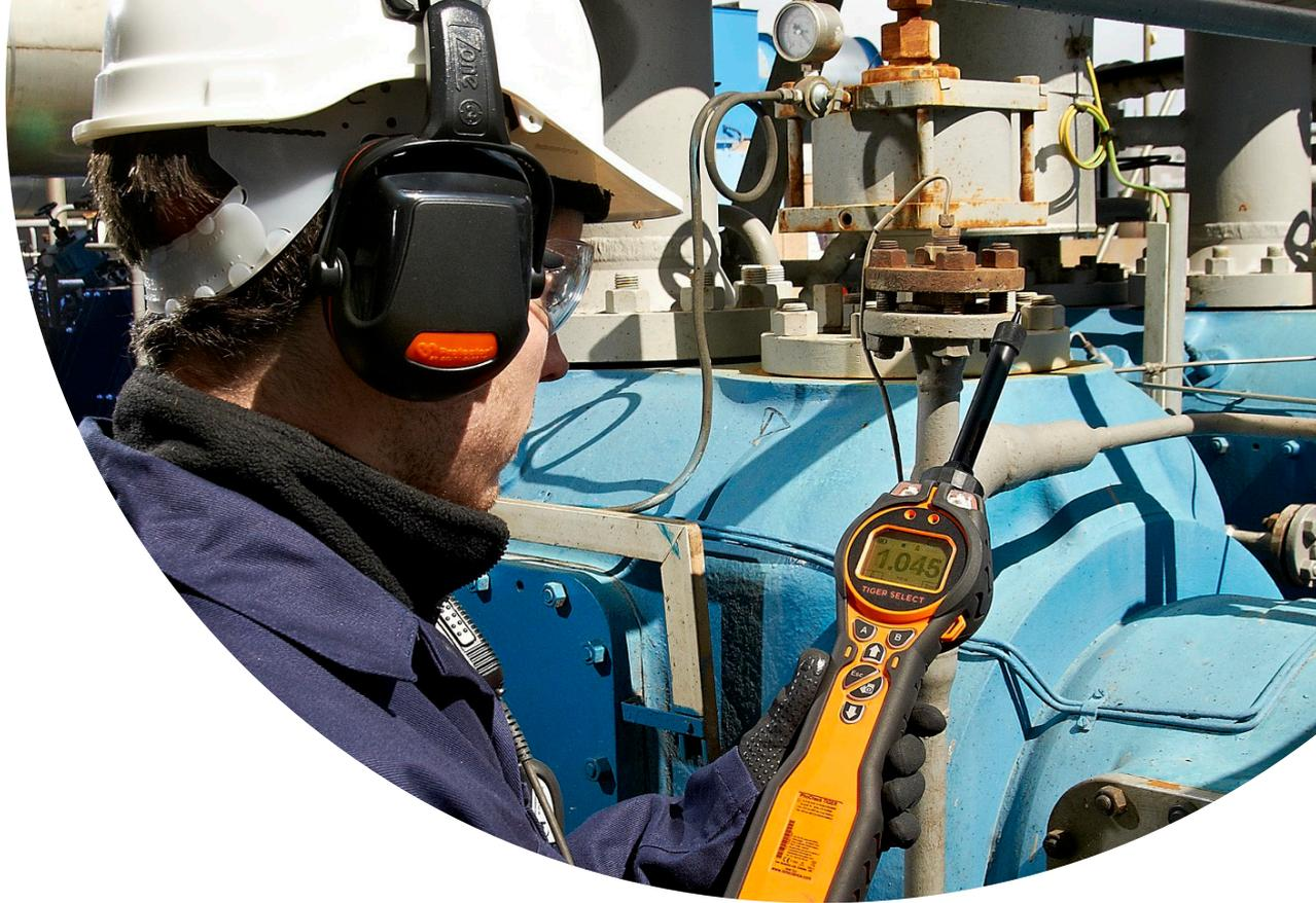
Un detector manual revolucionario, Tiger Select se puede operar o bien con un tubo anterior al filtro de benceno para detectar solamente el benceno o sin él, para detectar los compuestos aromáticos totales (TAC). Tiger Select se ha separado en dos modos sencillos de usar para simplificar y facilitar su uso: Básico y Avanzado. El usuario puede seleccionar cualquiera de los dos.
